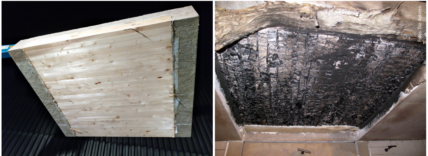
Abb. 3: Unter-/Holzseite des Probekörpers vor (links) und unmittelbar nach dem Brandversuch (rechts)
